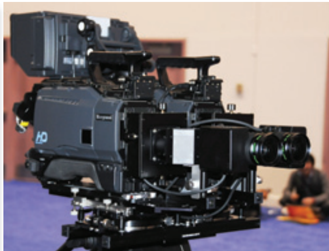
Система для стереосъемки на базе двух камер HDK-79EC/HS
