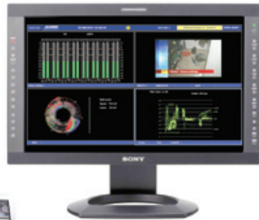
Монитор Sony, превращенный в измерительный прибор с помощью модуля VMM-4SNY
